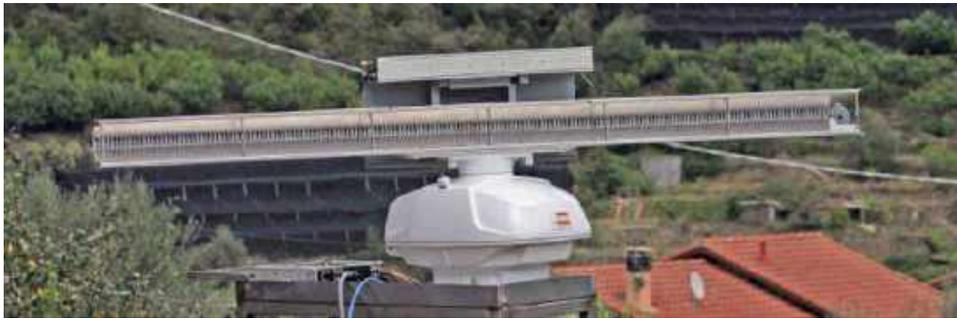
Cette impulsion est réfléchiée par une antenne qui résonne à la même fréquence que celle utilisée par le radar et on arrive ainsi, avec un équipement électronique de réception, à localiser la source réfléchissante. Dans notre cas, ce sera un frelon équipé de cette antenne. C'est ce que montre les photos ci-après.
